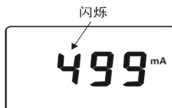
图14. 电流报警临界值设定
